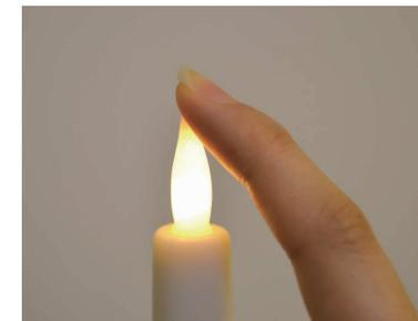
キャンドルの炎の部分が本体スイッチになっています。ぐっと下に押し込むとON/OFFの操作ができます。
